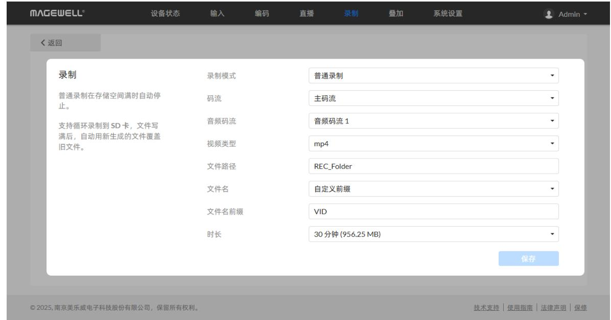
**配置录制参数** 设备支持exfat、ntfs、vfat格式的SD card，最大支持2T。单个vfat文件要求小于4G。录制前，请插入对应存储介质。
